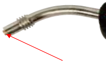
(1) Irrota MIG-polttimen etuosan osat.
