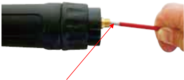
(5) Syötä uusi lankaputki varovasti polttimen johtoon asti niin, että se tulee ulos polttimen kaulasta.
