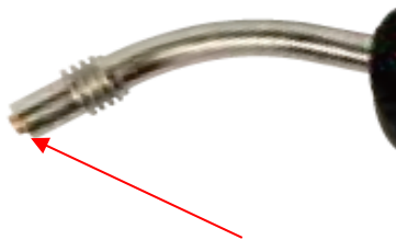
(1) Irrota MIG-polttimen etuosan osat.
