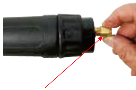
(6) Asenna lankaputken pidäinmutteri ja ruuvaa vain ½ kierrosta.
