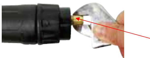
(9) Ruuvaa lankaputken pidäinmutteri kiinni ja purista tiukkaan.
